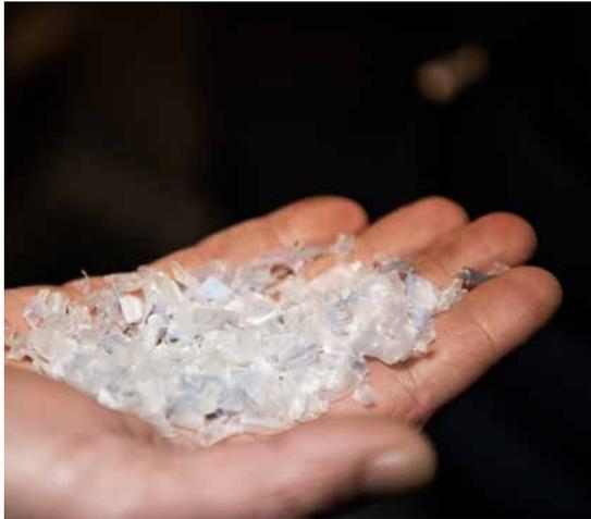
Auf Basis fingernagelgrosser Flakes und weiterer Arbeitsschritte produzieren Preform-Hersteller reagenzglasförmige Rohlinge, die von den Getränkeherstellern zu neuen PET-Flaschen aufgeblasen werden.
